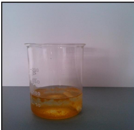
11. ábra Szürkevíz flokkulálás és ülepedés után
