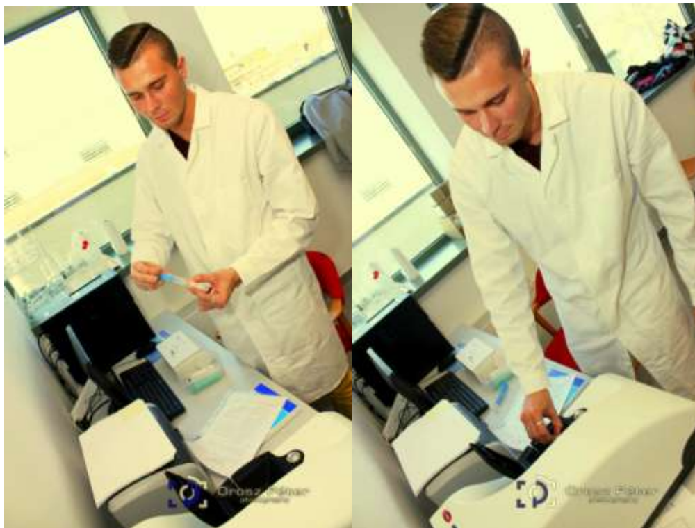
1. ábra Zéta-potenciál mérés előkészítése (Malvern Zetasizer NanoZ készülékkel) a Debreceni Egyetem Műszaki Kar Környezet- és Vegyészmérnöki Tanszék Vízminőségvédelmi laboratóriumában (Fotók: Orosz Péter)
