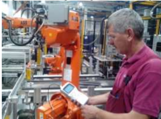
4. kép. Professzionális rezgésmérés digitális eszközökkel (Electrolux)
