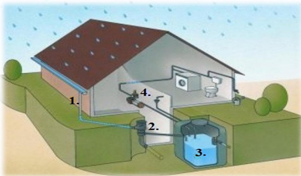
3. ábra Csapadékhaznosító rendszer felépítése [12]
