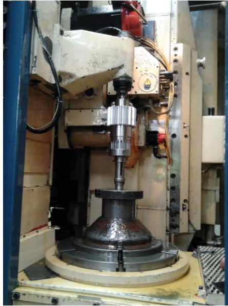
4. ábra. A FANUC vezérléssel felújított fogköszörűgép munkatere
