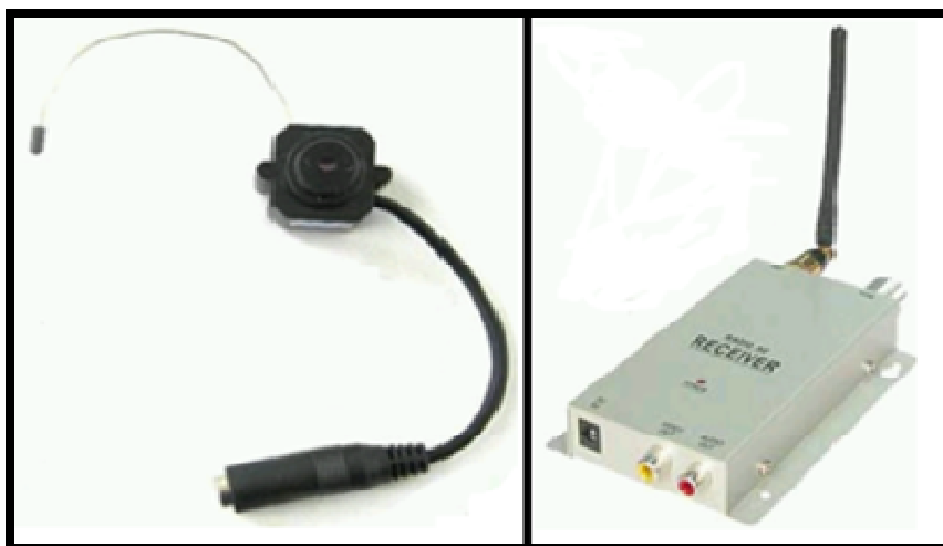
1. ábra Fedélzeti kamera (bal oldali kép) és a vevő egység (jobb oldali kép)
